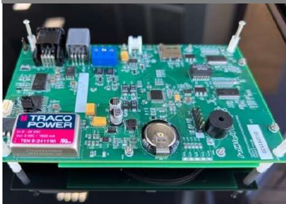
СИЛОВЫЕ УСТАНОВКИ (АКБ и BMS)
